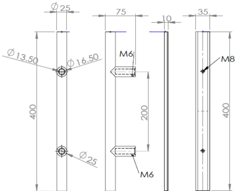
**Vorbereitung: Bohrung  $\varnothing 14$ mm gemäß dem gewählten Befestigungsabstand**
